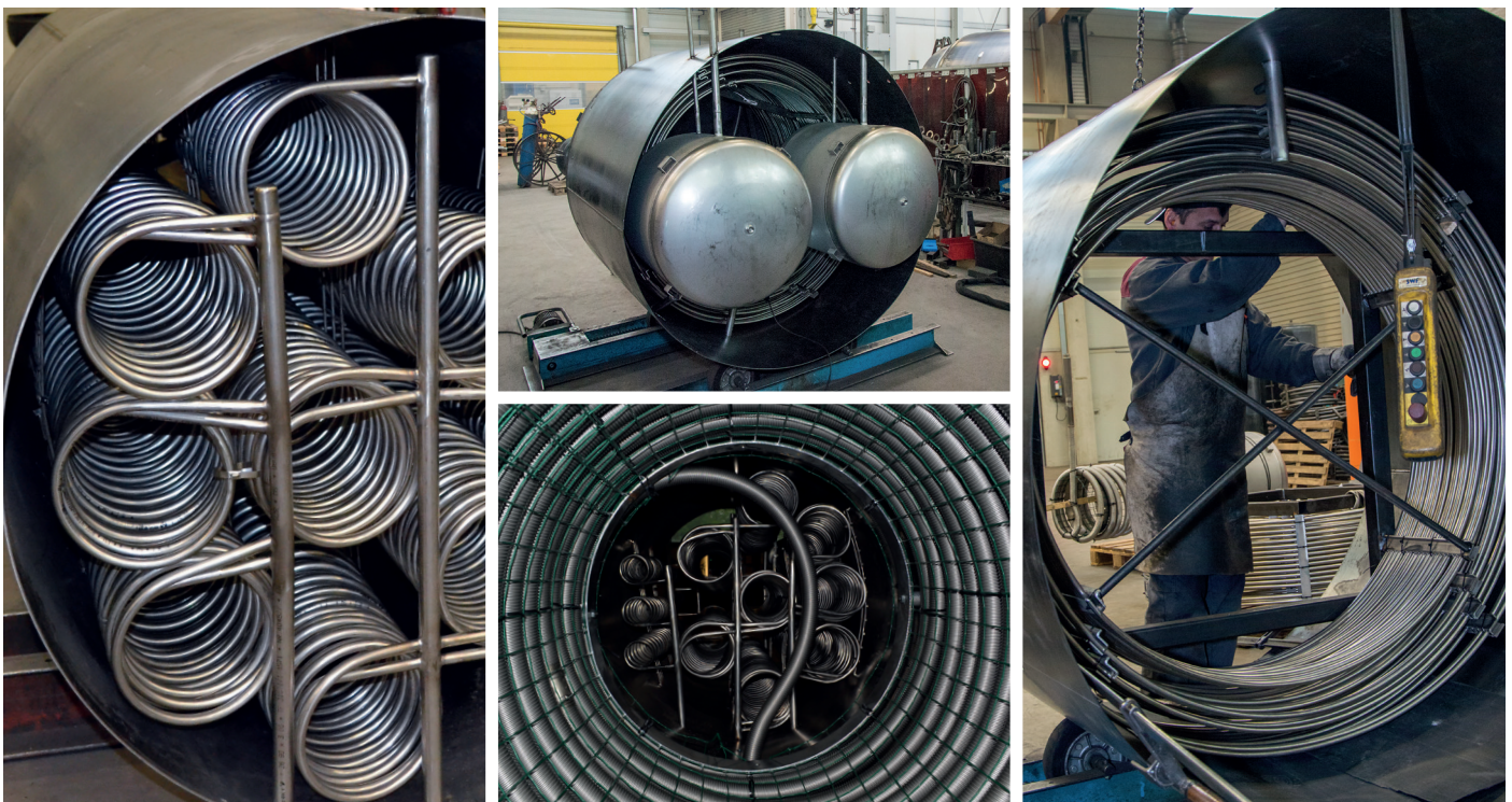
Anlagenbeispiele – WRG-Speicher, 2.850 ltr., Höhe 3.820 mm, 3 WRG-Tauscher und 1 Wellrohrtaucher (links u. mitte unten); WRG-Speicher, 3.600 ltr., Höhe 2.070 mm, 2 WRG-Tauscher und 2 Integralboiler (mitte oben u. rechts).
