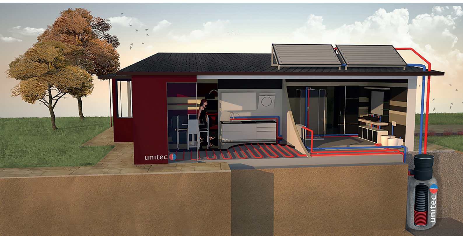
Solarthermieanlage für kombinierte Warmwasserbereitung und Heizungsunterstützung.
