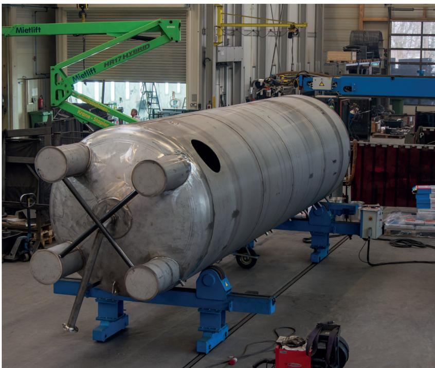
**Industrieanwendung** – 30.000 Liter, 9.050 mm Höhe, V4a, 10 bar, 5 Wärmetauscher
